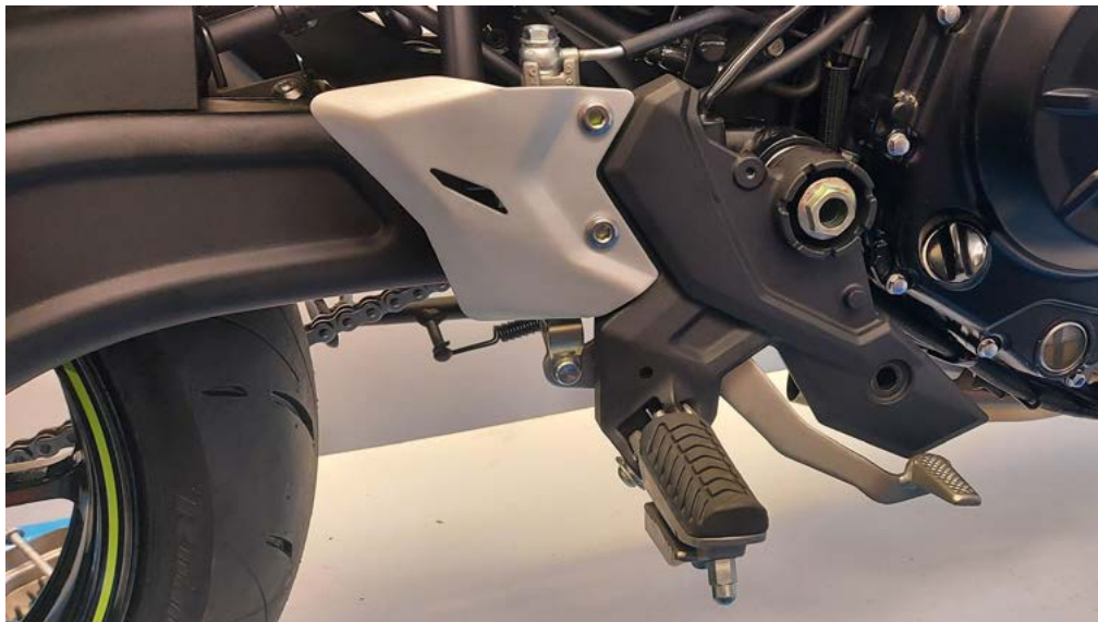
PHOTO 10 (KAWASAKY NINJA 650) LOOSEN THE DRIVER'S R.H. FOOTBOARD
